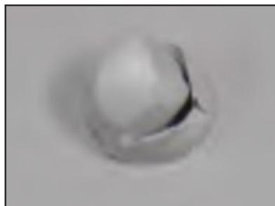
TYPICAL THERMOPLASTIC FAILURE
