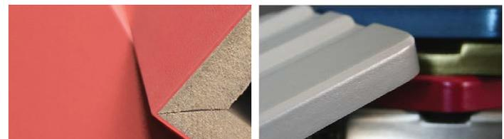
热塑性塑料提供了一个更细洁的表面光洁度，用它进行加工的结果，可以减少边缘剥落或开裂的机会。热塑性塑料通常适用于中密度纤维板或木垫板提供刚度和结构支持，中密度纤维板可用传统的木加工设备加工从而获得理想的美学设计效果。有一个成型的过程，称为膜压成型。过程包括加热热塑性塑料片材再热压基材，热塑性塑料片插入机器热压直至成型。
